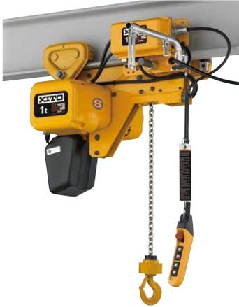
A talha elétrica de corrente de baixa altura construtiva KITO foi projetada para ter uma altura menor do que a das configurações usuais da Série NER. Este produto é o mais adequado para instalações de teto baixo ou para maximizar a altura de elevação. Troles são opcionais e disponíveis sob pedido. Para exigências especiais, tais como capacidades acima de 10t, dupla velocidade ou vigas com raio de curvatura, consulte o representante da KITO mais próximo.
